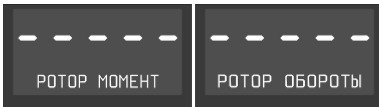
Рисунок 17. Показания в окне параметра модуля индикации при потере связи с датчиком
