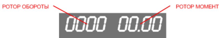
Рисунок 11. Отображение момента и оборотов ротора на МУ-140
